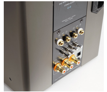
背板上四個撥桿由左至右分別是三段增益切換，左、立體聲、右聲道切換，光纖/同軸數位輸入切換，Enable/Disable開關設定。
